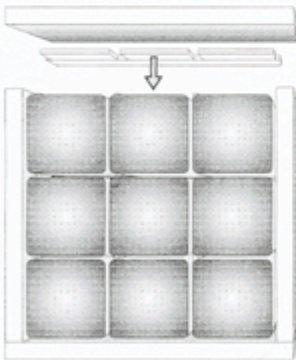
KUVA 4. Mikäli mahdollista asenna lopuksi yläpuolen asennuslista ja asennuskehys. Käytettäessä asennuksessa valmiista kehikkoon tai valmiiksi mitoitettua asennusaukkoa asennetaan ylin lasitiilirivi siten, että ylälistaa jätetään asentamatta ja ylin lasitiili on ala- ja sivuasennuslistojen varassa. Pursota tällöin silikonia ylimmän lasitiilen yläpinnan ja asennuskehiksen/ asennusaukon väliin siten, että tiili liimautuu myös yläpinnaltaan.
